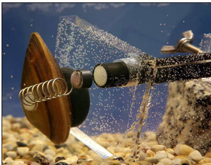
Ryc. 12. Małż na postumencie z zamontowaną sondą i magnesem
