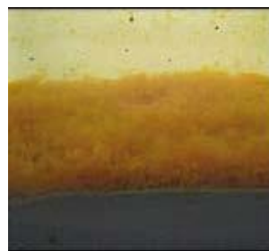
Фото 4. Однородный слой коагулянта после осаждения на поверхности донных осадков – лабораторные условия (аквариум 10х10х20 см), недостижимое в натуральных условиях в водоёме.
