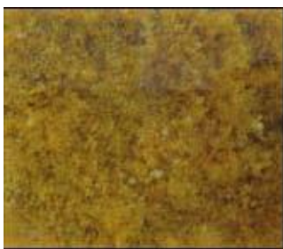
Фото 4. Однородный слой коагулянта после осаждения на поверхности донных осадков – лабораторные условия (аквариум 10х10х20 см), недостижимое в натуральных условиях в водоёме.
