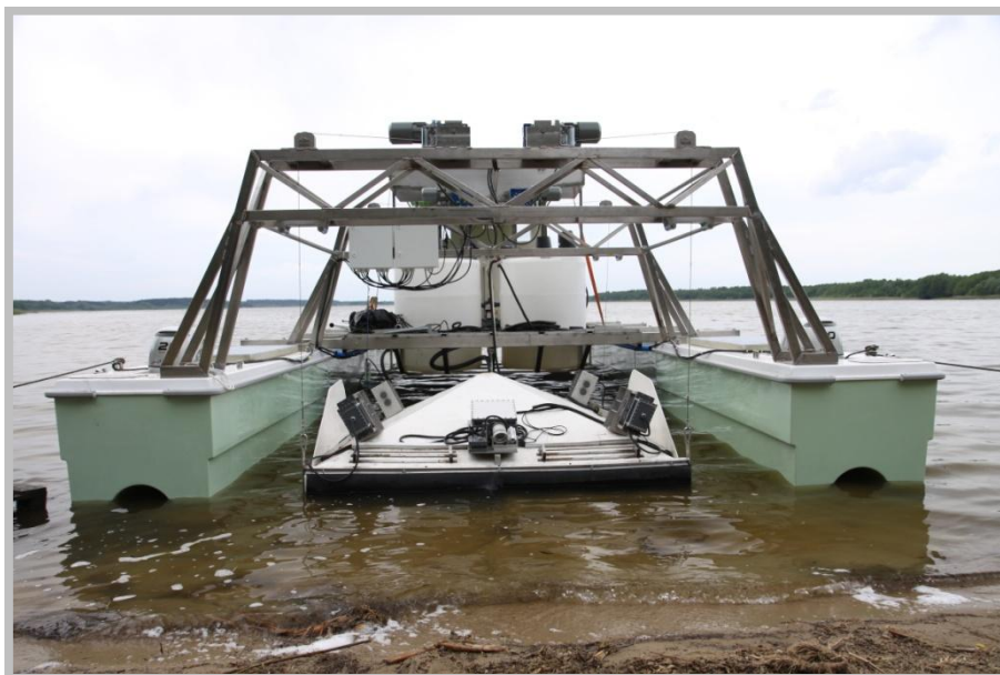
Rys.10. Jednostka pływająca z widocznym modulem podwodnym zawieszonym na doku modułu nawodnego. Z uwagi na niską przejrzystość wody w trakcie prowadzenia prac niemożliwe jest przedstawienie zdjęć modułu podwodnego w trakcie prowadzonej aplikacji
